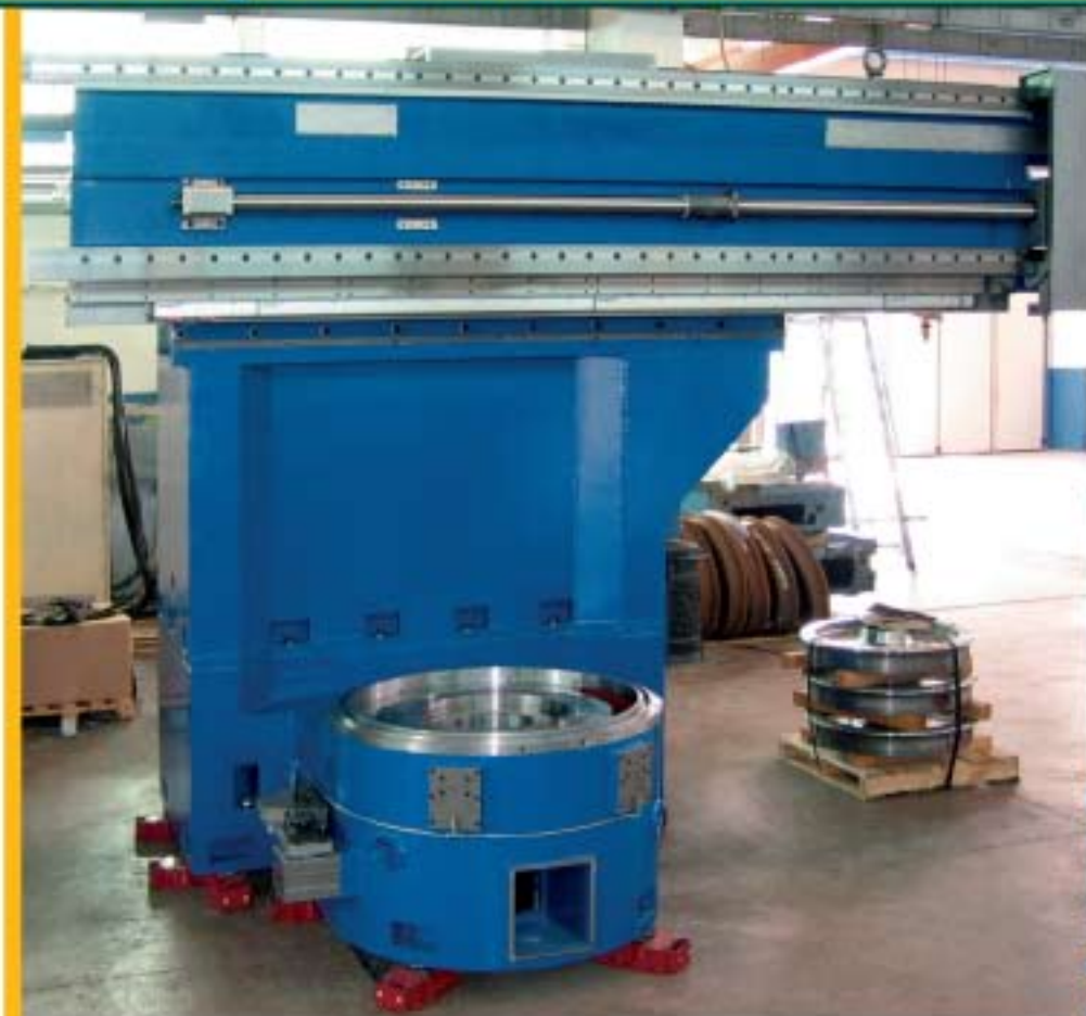
La macchina è caratterizzata da una struttura a montante fisso con traversa fissa
