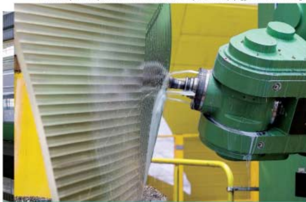
Particolare pala elica portaerei Cavour in lavorazione su Speedram 2 equipaggiata con testa tilting
