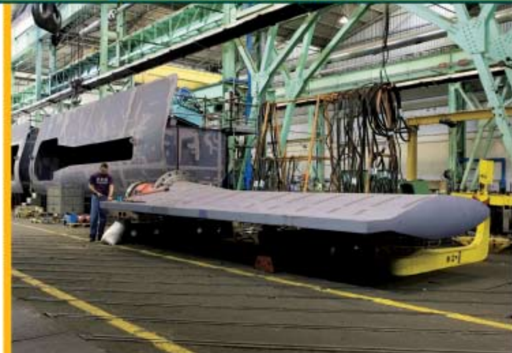
Impianto stabilizzatore Gr5 per nave Cruise al montaggio
