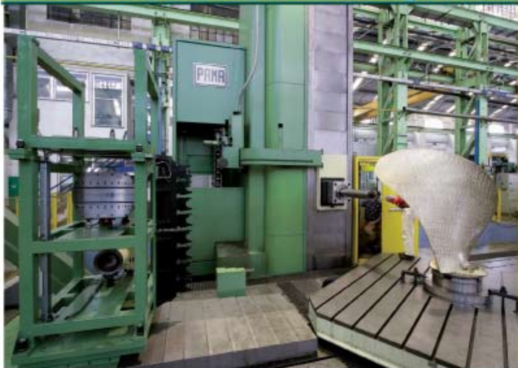
Pala elica fregata classe Orizzont in fase di collaudo su Speedram 2000
