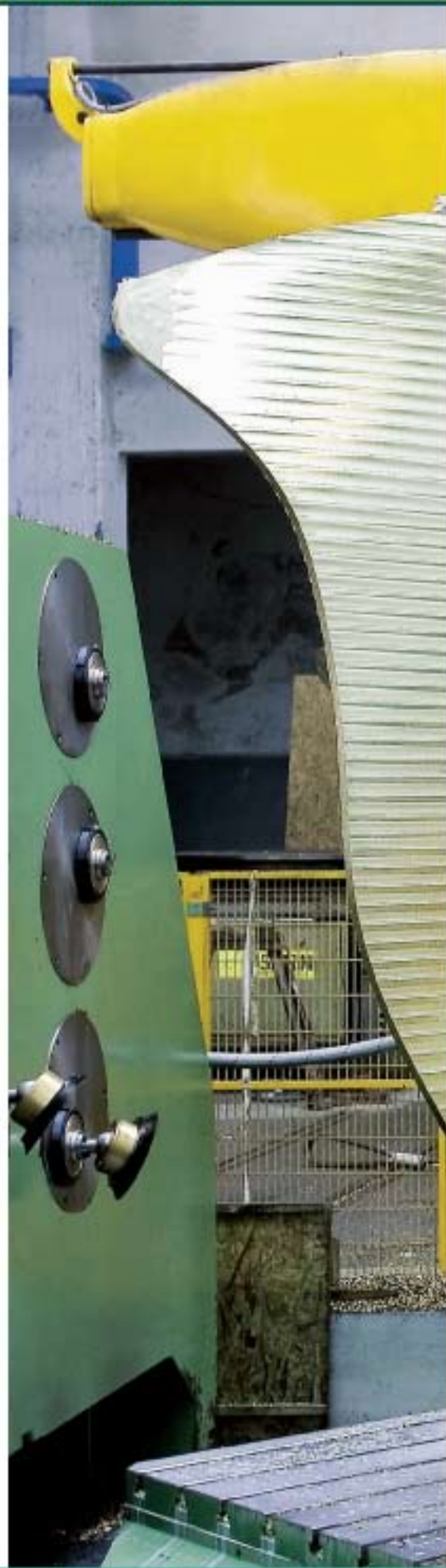
Pala elica portaelica Cavour posizionata su attrezzatura per lavorazione su Speedram 2
