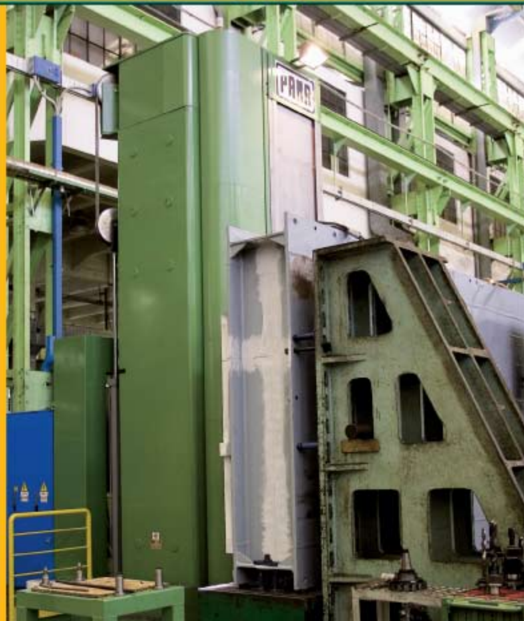
Particolare pala elica portaerei Cavour in lavorazione su Speedram 2 equipaggiata con testa tilting
