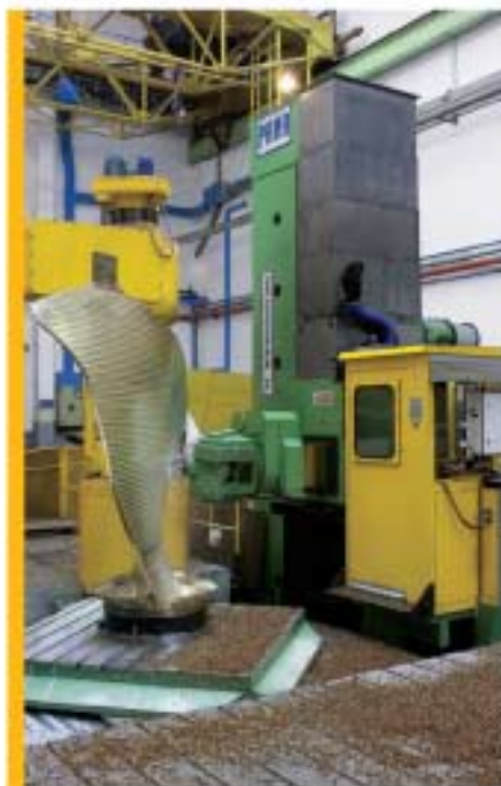
Pala elica portaelica Cavour posizionata su attrezzatura per lavorazione su Speedram 2
