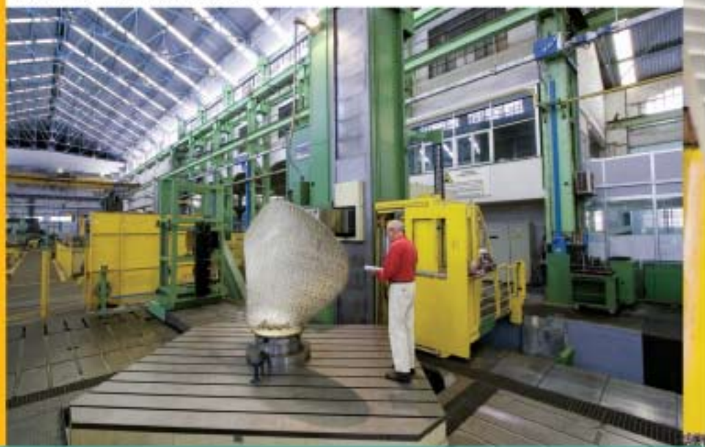
Pala elica fregata classe Orizzont in fase di collaudo su Speedram 2000, con pick-up accessori e magazzino-cambio utensili automatico
