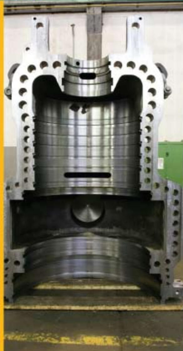
Semicassa turbina a vapore interamente lavorata su Speedram 2000
