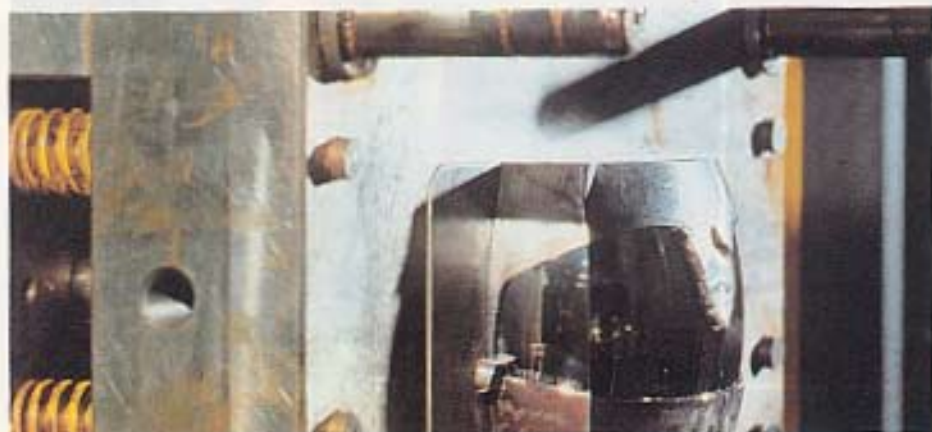
Stampaggio ad iniezione di parti ottiche finite (stampo di proprietà dell'Italocremona)
