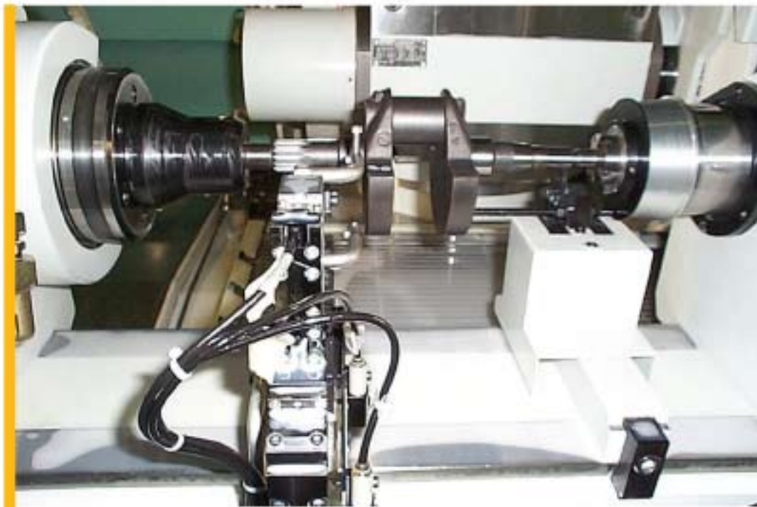
Sopra l'isola di lavorazione dell'albero motore e qui un albero motore in fase di rettifica
