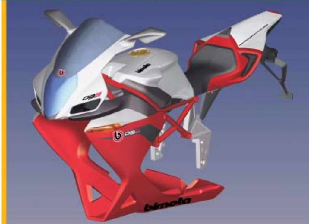
L'insieme telaio e carena progettata con NX di UGS
