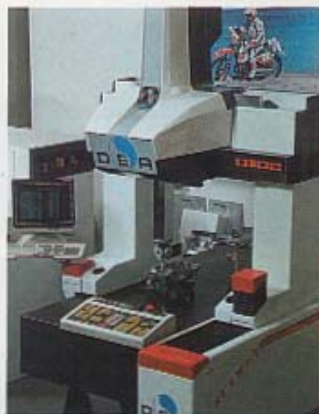
Molto importante il controllo qualità - Nella foto un sistema di misura tridimensionale
