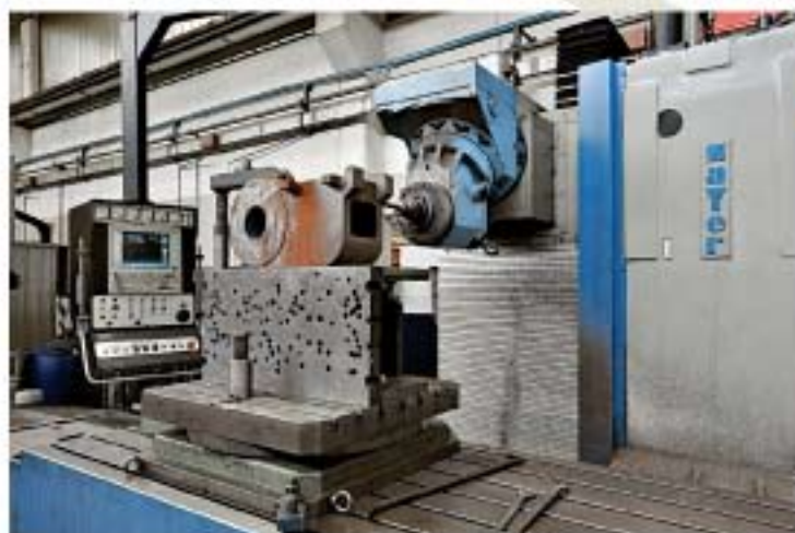
Testa della 20 KF 3000 in lavorazione su fusione in ghisa
