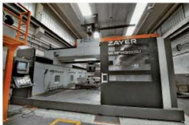
Memphis 6000 U Zayer, dotata di due teste twist a cinque assi con cambio automatico delle teste
