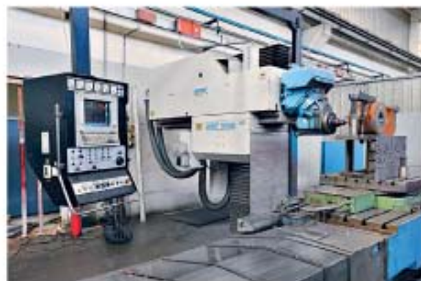
20 KF 3000 di Zayer: macchina a banco fisso in grado di finire il pezzo in macchina operando su cinque facce
