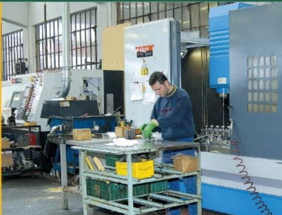
Il centro di lavoro verticale a montante mobile VTC 200C
