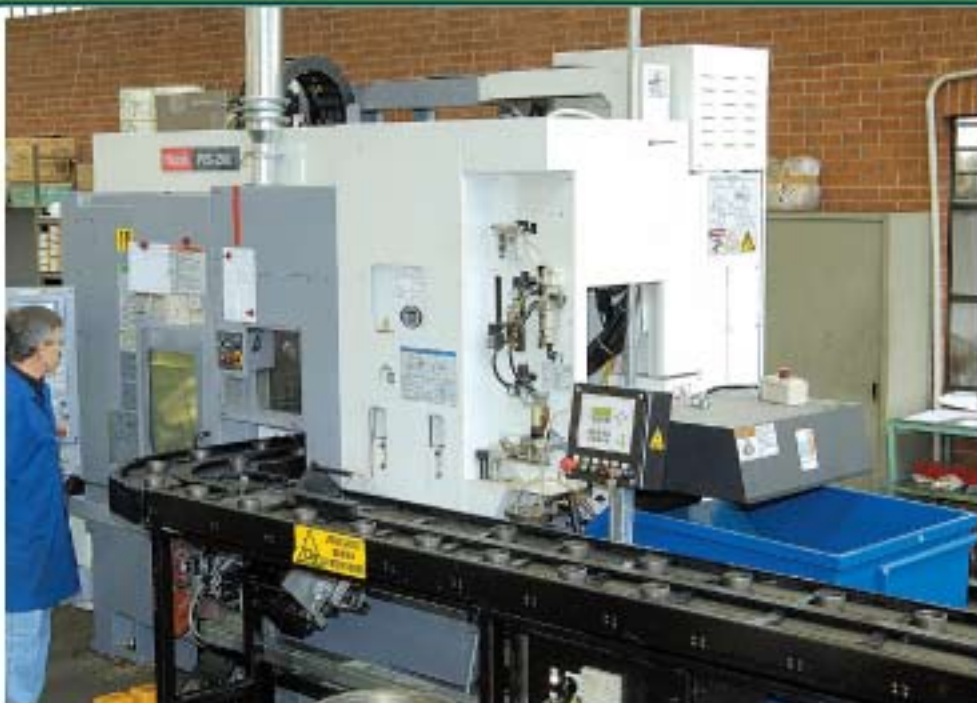
Il centro di tornitura ad asse verticale e mandrino rovesciato IVS 200 è dotato di un sistema di carico e scarico automatico, asservito da un nastro trasportatore, che permette alla macchina di operare in modalità non presidiata
