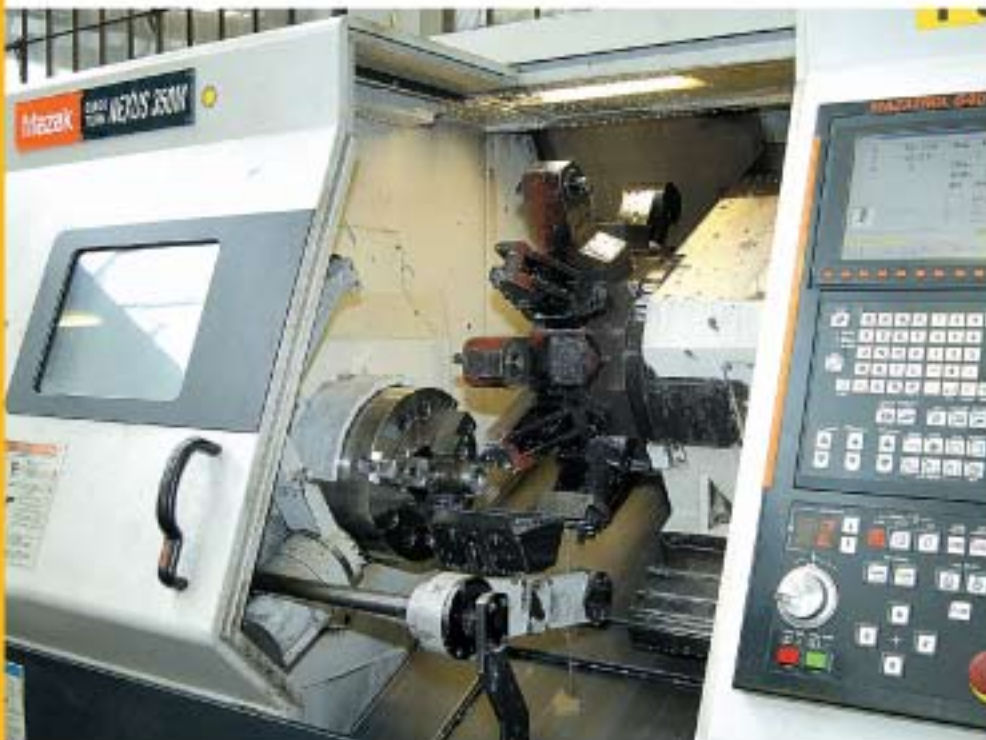
Il centro di tornitura avanzato Quick Turn Nexus 350M con utensili motorizzati sulla torretta a tamburo dodecagonale
