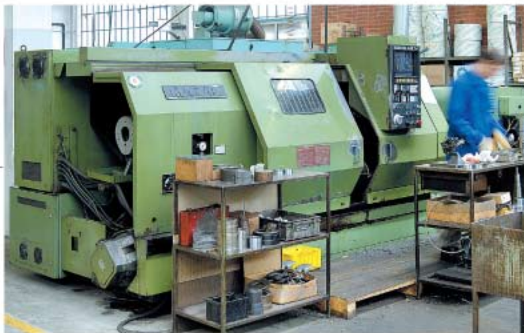
Il tornio a quattro assi a controllo numerico entrato in azienda vent'anni fa
