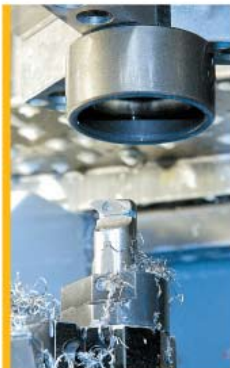
Progettata per particolari di elevata precisione, la serie IVS può tornire materiali persino più duri di HRC 50 senza necessità di rettifica
