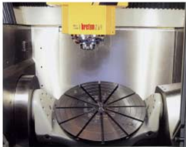
La tavola rotolante della Xceeder Micron in uso alla Breton
