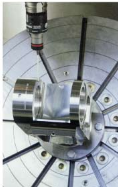
Un particolare in costruzione e poi in verifica dimensionale sulla Xceeder Micron 900 RT
