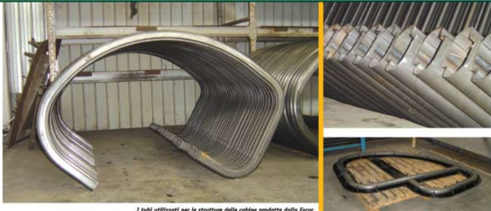
I tubi utilizzati per le strutture delle cabine prodotte dalla Escar
