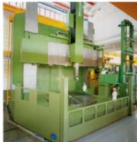
Un Tornio AP 80 TM dotato di corsa Z di 4000 millimetri
