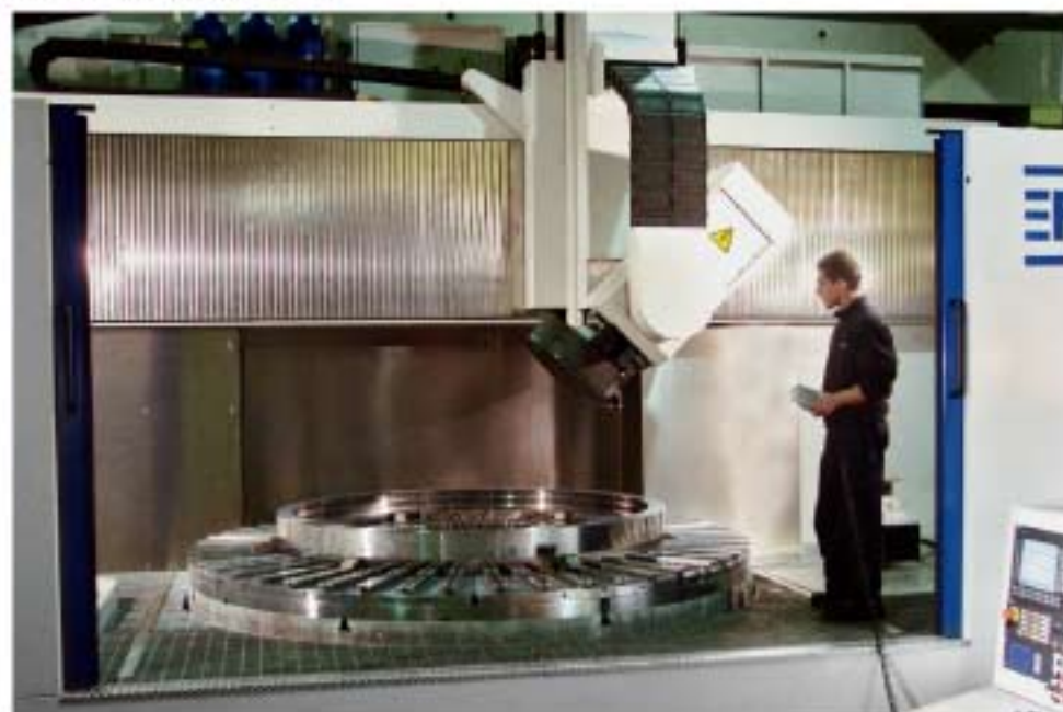
A sinistra la rettificatrice della FMT in fase di lavorazione
