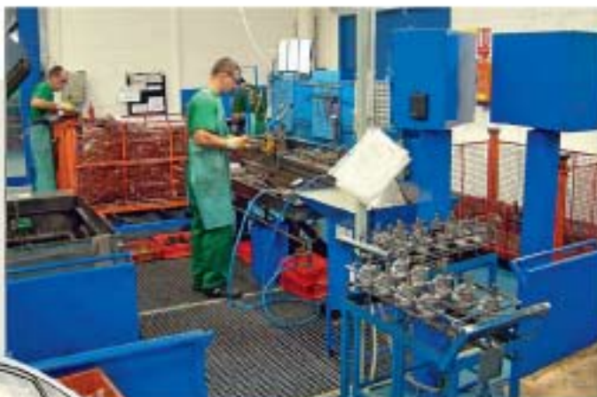
Un operatore nella fase di smontaggio di una scatola sterzo di TRW
