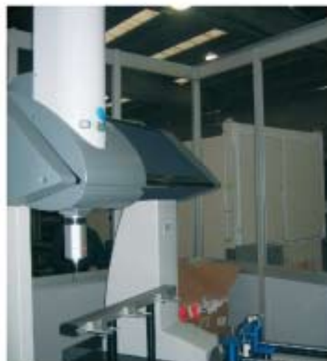
La linea di produzione teste prevede la verifica di tutta la produzione realizzata con la macchina della Dea
