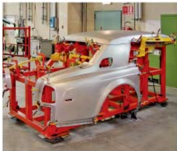
Particolare rivestimento posteriore fianchetto in alluminio montato su calibro di controllo per verifica giochi e rifile
