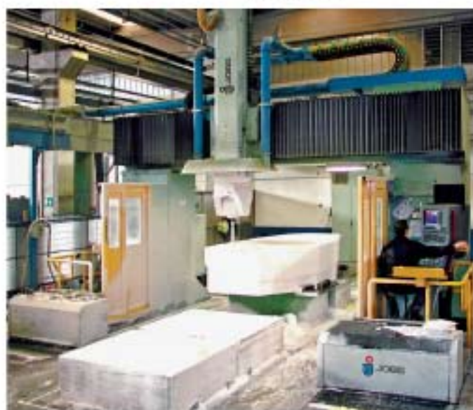
Jobsch 25 è il centro di fresatura Jobs ad alta velocità, dotato di tecnologia convenzionale di trazione degli assi, concepito per la lavorazione dei modelli di stile
