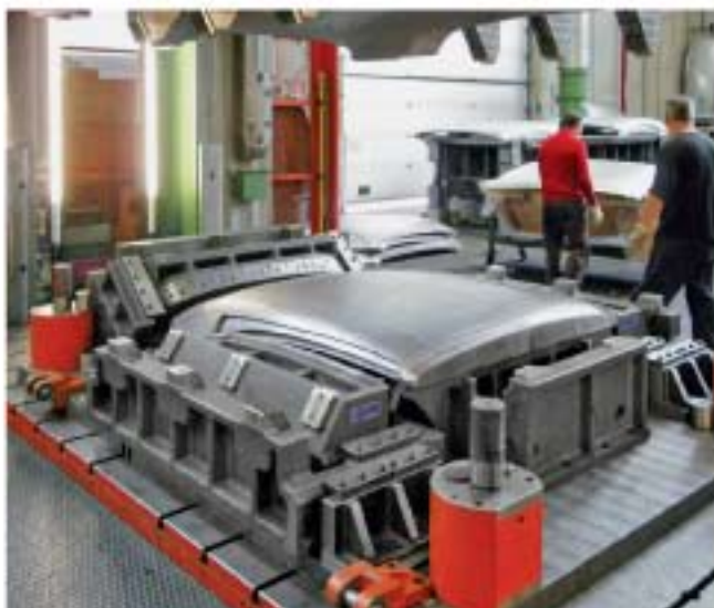
Operazione di flangiatura del particolare rivestimento padiglione in alluminio
