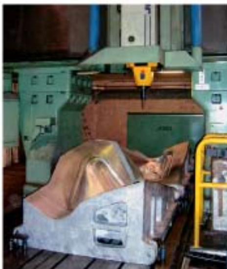
Jomach 243 è il centro di fresatura Jobs ad alta potenza con tecnologia convenzionale di trazione degli assi, dotato di dispositivo cambio automatico delle teste di fresatura. Adottato da Model Master principalmente per le lavorazioni di sgrassatura degli stampi
