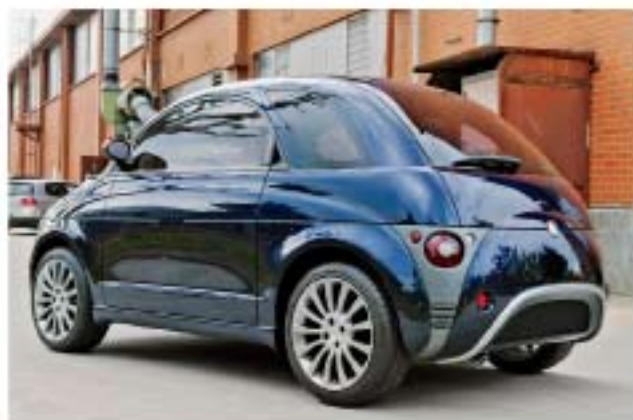
Citycar "Mitica", concept finalizzato allo studio di moduli di carrozzeria e d'interni identici, per ridurre costi di progettazione e investimenti produttivi
