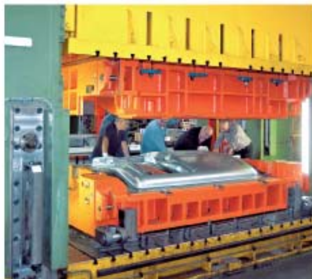
Fase di ricerca durante lo stampaggio di imbottitura del particolare rivestimento fiancata
