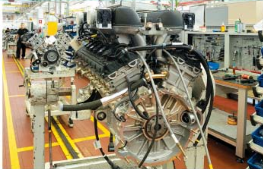
Un esempio di Motore V12 6.5L per vettura Murbìologo LP640 (longitudinale posteriore 640 CV), interamente prodotto a Sant'Agata e sotto un albero motore del V12 in fase di montaggio
