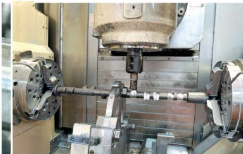
L'Integrex e-410 H con il quale viene eseguito l'intero processo di lavorazione degli alberi a camme, degli alberi motore e dei differenziali posteriori e sotto un momento della lavorazione dell'albero a camme sull'Integrex e-410 H
