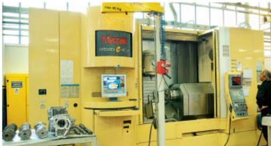
L'Integrex e-410 H con il quale viene eseguito l'intero processo di lavorazione degli alberi a camme, degli alberi motore e dei differenziali posteriori e sotto un momento della lavorazione dell'albero a camme sull'Integrex e-410 H
