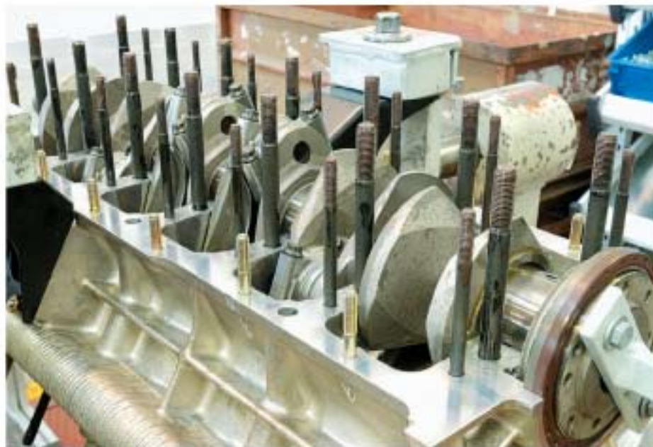
Un esempio di Motore V12 6.5L per vettura Murbìologo LP640 (longitudinale posteriore 640 CV), interamente prodotto a Sant'Agata e sotto un albero motore del V12 in fase di montaggio
