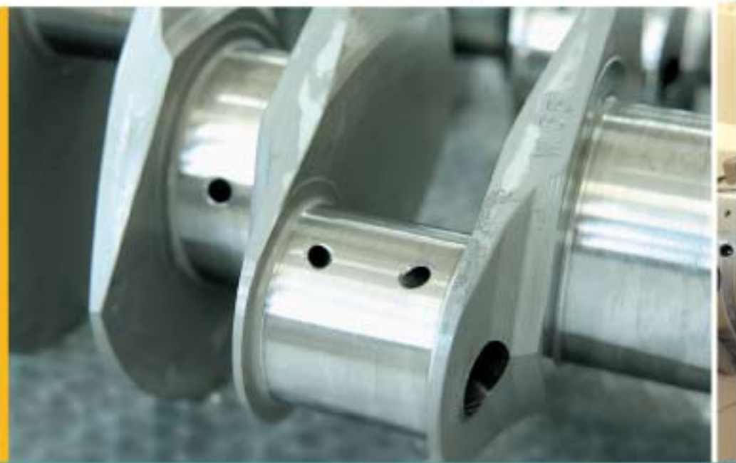
Un particolare dell'albero motore con fori del circuito olio fuori asse sul perno di biella.
