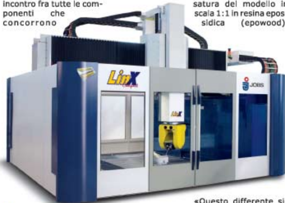
Centro di fresatura LinX Compact ad altissime prestazioni con motori lineari per rapidi fino a 50 m/min, equipaggiata con testa portamandrino continua Twist T2K-S a cinque assi (40 kW - 24000 giri/min, attacco HSK-A-63)
