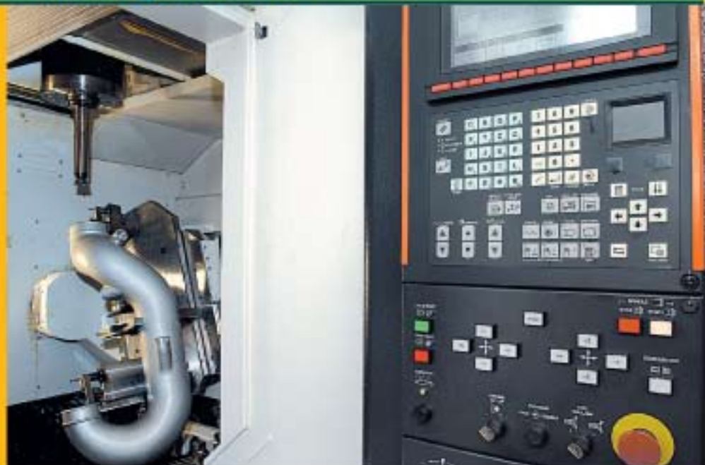
La programmazione del Variaxis avviene attraverso il controllo conversazionale Mazatrol Fusion 640M
