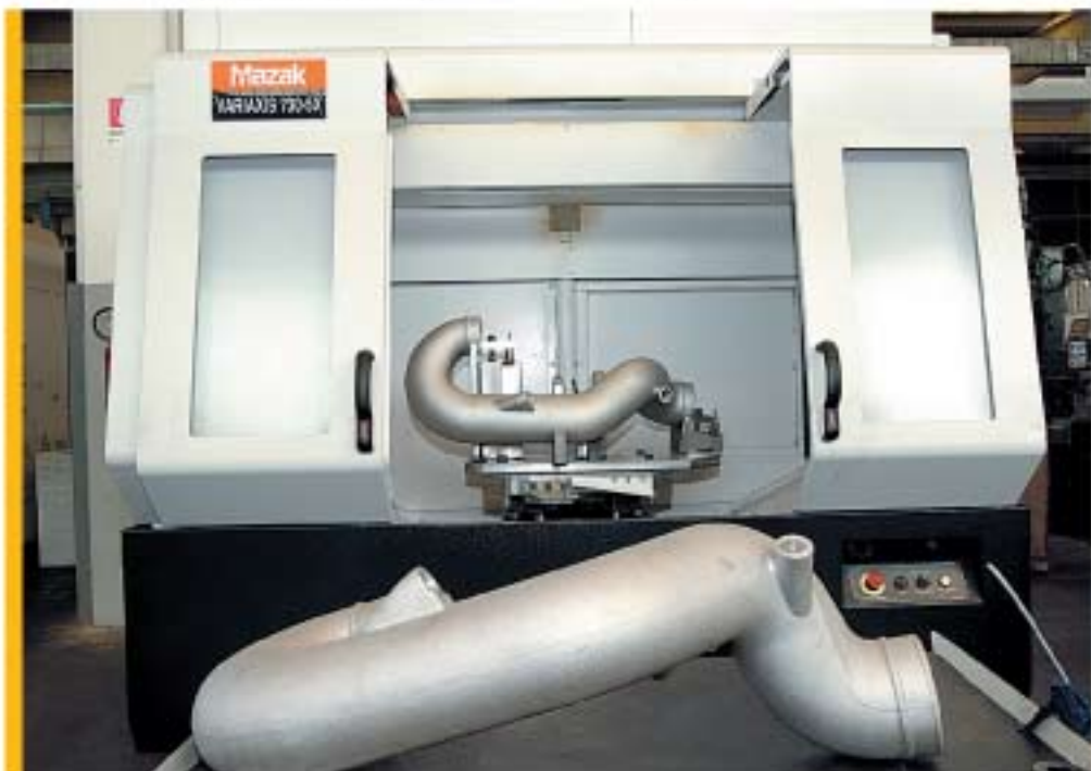
Il cambio pallet a due posizioni consente la preparazione del pezzo successivo e la sua sostituzione durante la lavorazione
