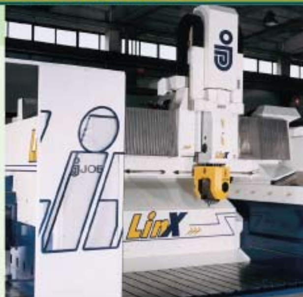
■ Qui sopra LinX con motori lineari a sinistra Jomach 156
