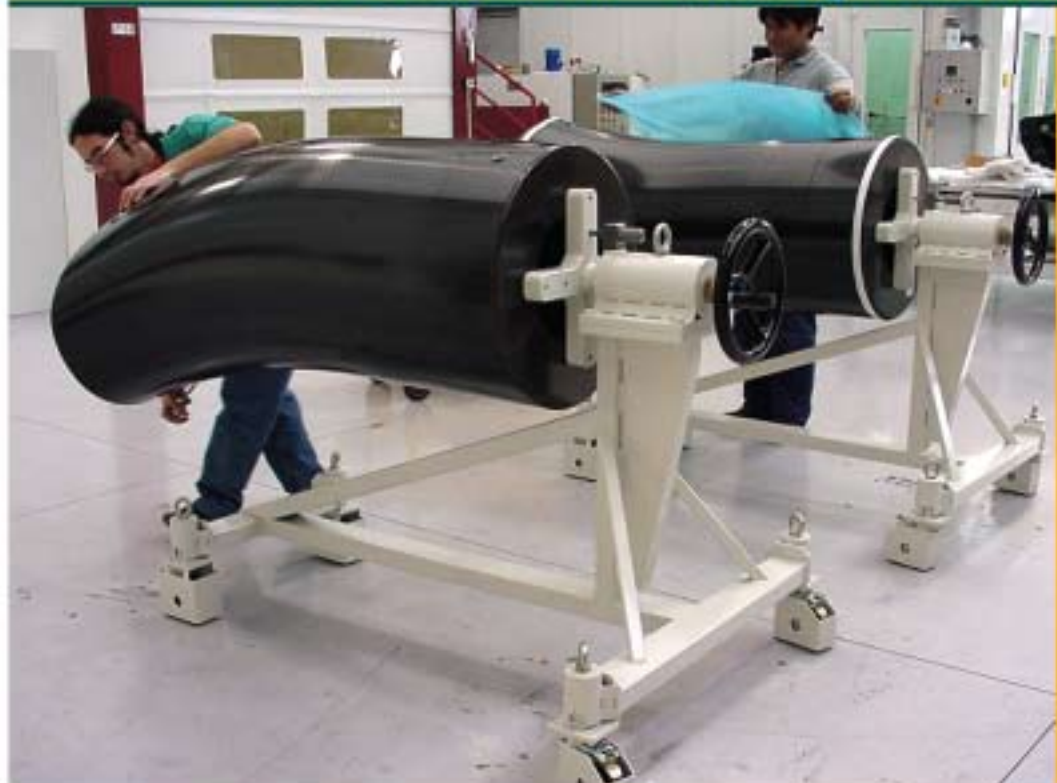
Sopra stampi per condotti d'aspirazione in carbonio, sotto stampo in carbonio per chiglia di elicottero
