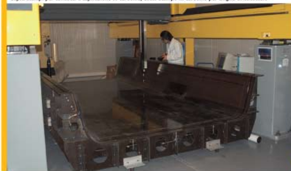
Sopra stampi per condotti d'aspirazione in carbonio, sotto stampo in carbonio per chiglia di elicottero
