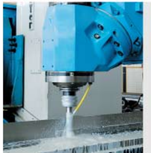
Particolare in titanio in lavorazione su KPU AR 4000 Zayer
